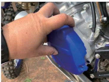
付属のボルト (M6×30等) に交換し、簡単に装着できる。Oリングが内蔵されているのでフィット感も上々だ
