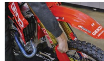
ツイストダイヤルを回し、固定するための爪を出す。
