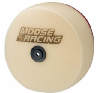
接着されたデュアルフォームが、最大限の保護と通気性を実現。外側は粗く、内側は細かいフォームを採用し、防塵性が高く吸気率も兼ね揃えている。すべての縫い目に、柔軟な接着剤を使用してひび割れを防ぎ、スーパーシールネオブレッシングが水を遮断します。
